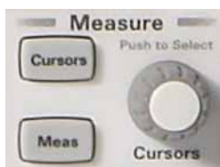
Illustration 10 Bouton rotatif des curseurs de mesure
