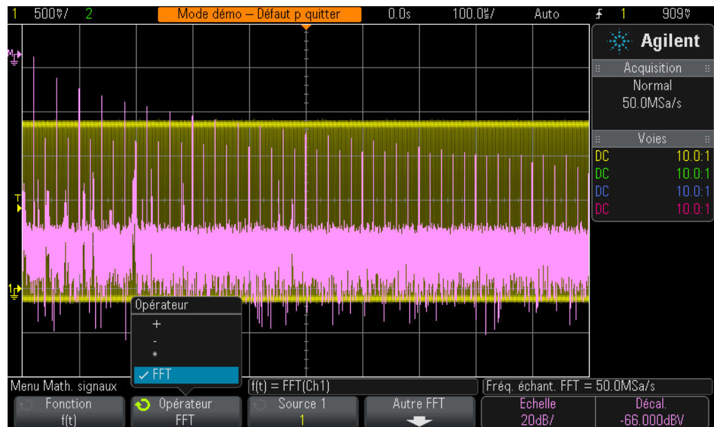
Illustration 43 Fonction mathématique FFT sur une horloge numérique répétitive
