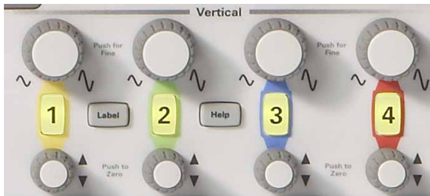
Illustration 5 Commandes verticales (axe Y) de l'oscilloscope
