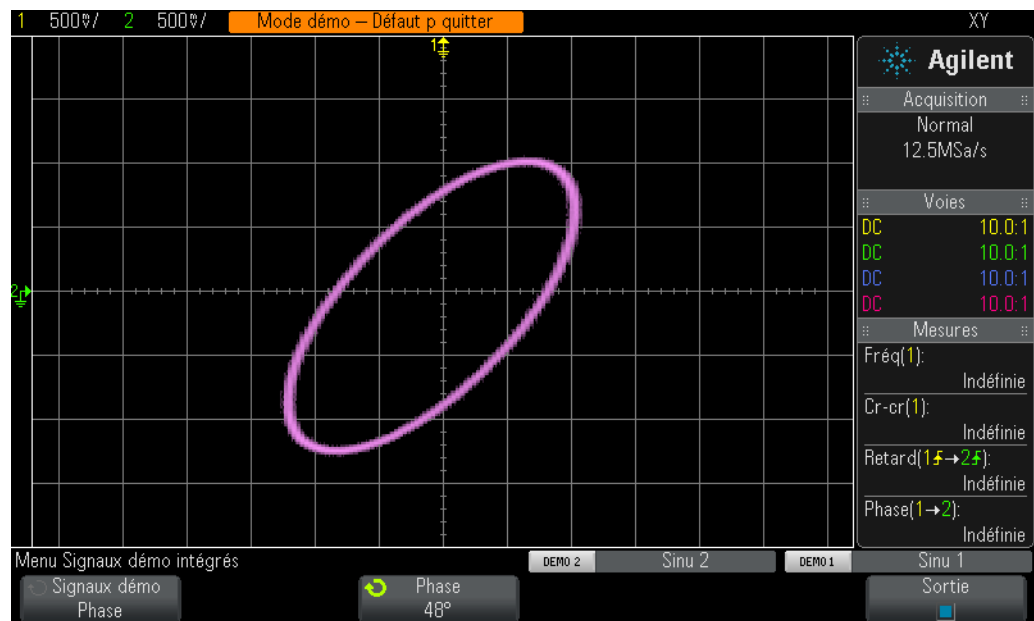
Illustration 40 Modèle de Lissajous au moyen du mode XY des deux ondes sinusoïdales de même fréquence, mais avec un déphasage de 48^\circ l'une par rapport à l'autre
