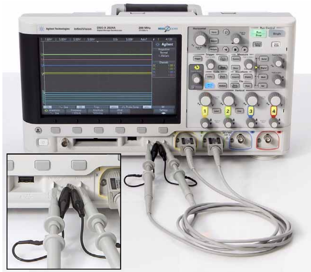
Illustration 8 Connexion des sondes entre les entrées voie 1 et 2 et les bornes de sortie des signaux démo
