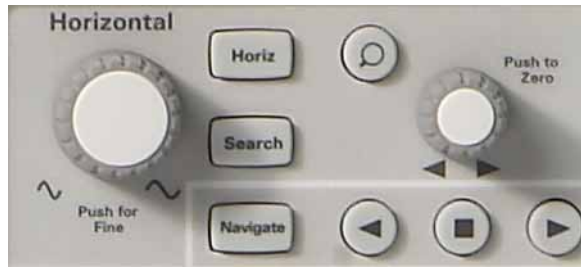
Illustration 4 Commandes horizontales (axe X) de l'oscilloscope
