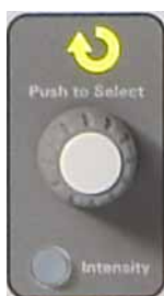
Illustration 7 Commande d'entrée générale de l'oscilloscope
